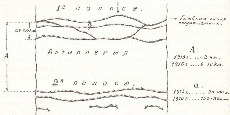
Черт. 43. Схема укрепленной позиции с конца 1914 г. до середины 1917 года.
