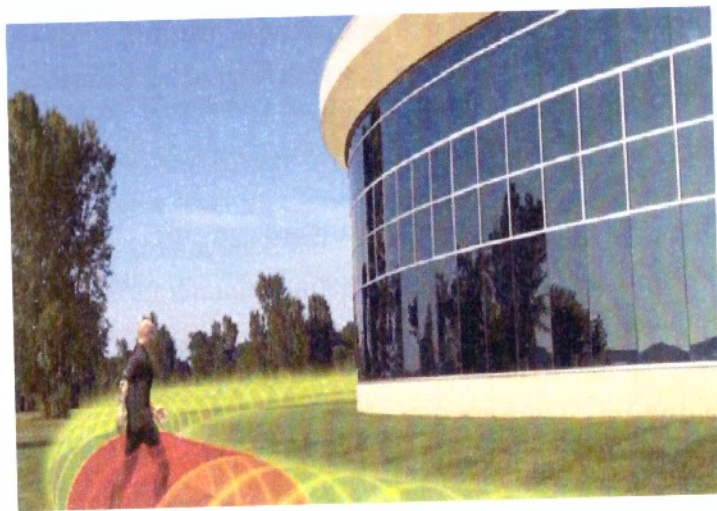
Фиг. 5. Детекция чрез нарушаване на електромагнитно поле, създадено от кабели, монтирани под земята
